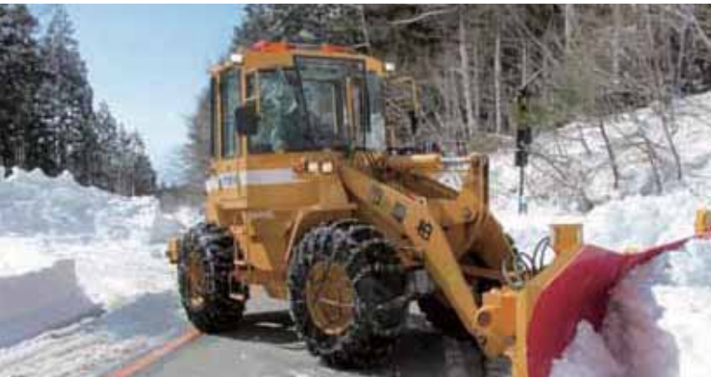
柏崎市からの除雪用重機
