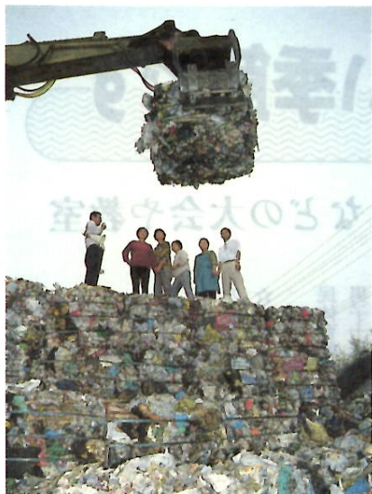
上も下もゴミ ゴミを圧縮して積み上げます
