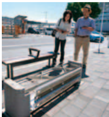
解体すると炊き出し釜が現れます
