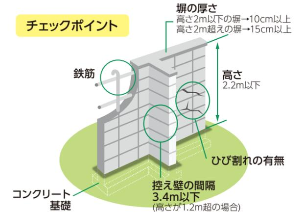
過去に発生した宮城県沖地震などの被害を踏まえて、昭和56年に建築基準法が大幅に改正。塀の高さの上限は、補強コンクリートブロック造の塀は2.2m、石造やれんが造などの組積造の塀は1.2mです。壁の厚さは、高さが2m以下の場合10cm以上、高さが2mを超える場合は15cm以上必要。また、ブロック塀には3.4m以下ごとに控え壁の設置が必要です。
