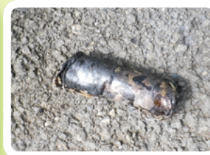
火災の原因とみられる充電式電池
