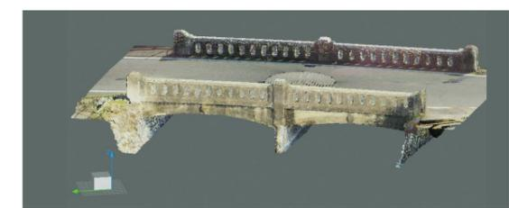
4 旧橋の解体前には三次元レーザー測量によりデジタルデータとして保存。
