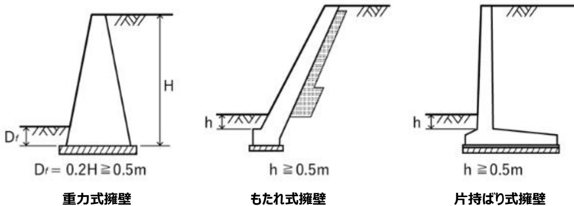
図 3-15 擁壁の直接基礎の根入れ
