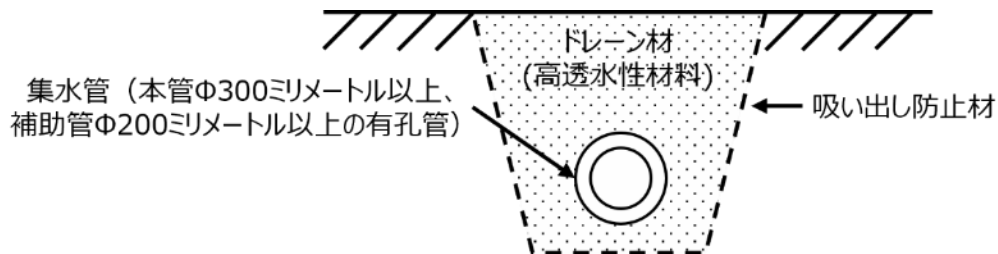
図 3-50 暗渠排水工の基本構造
