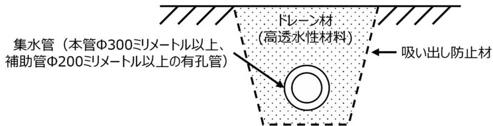
図 3-50 暗渠排水工の基本構造
