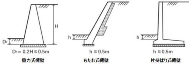
図 3-15 擁壁の直接基礎の根入れ
