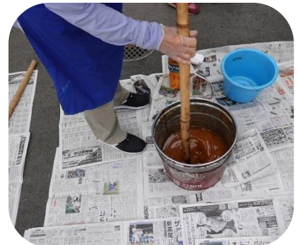
ドラム缶に苛性ソーダ・水・廃食用油を入れ、棒でかき混ぜます。
