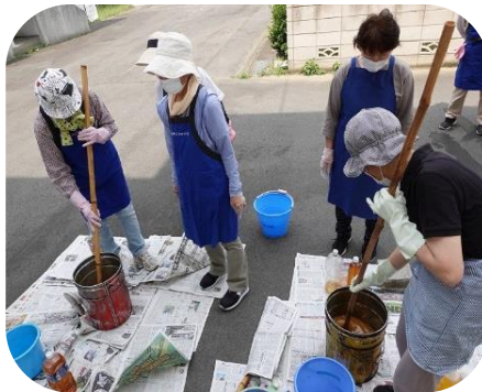
ドラム缶に苛性ソーダ・水・廃食用油を入れ、棒でかき混ぜます。
