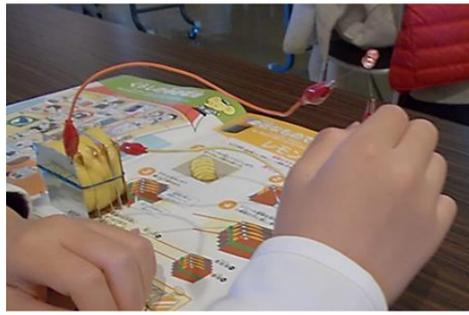
レモン電池でLED電球が光る様子
