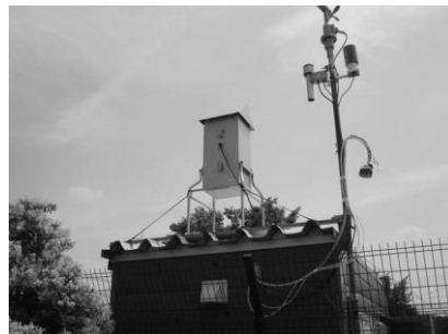
写真「ハイボリュームエアサンプラー」 ニッケル化合物、マンガンなどの重金属類を捕集
