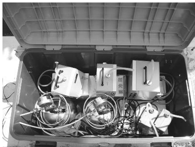
写真「キャニスター及び吸引装置」 ベンゼン、トリクロロエタンなどの揮発性有機化合物を捕集
