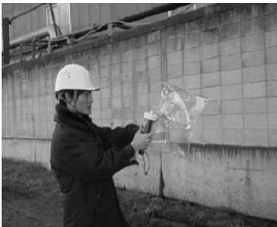
写真「気体排出口でのサンプリング」
