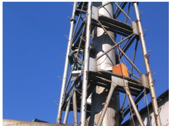
写真「気体排出口でのサンプリング」
