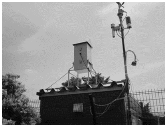
ハイボリュームエアサンプラー ニッケル化合物、マンガンなどの重金属類
