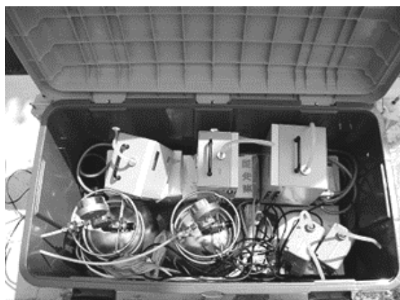
キャニスター及び吸引装置 ベンゼン、トリクロロエチレンなどの 揮発性有機化合物
