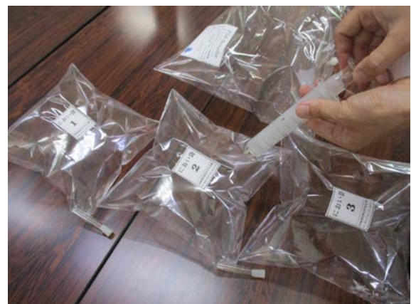
測定のため臭気を希釈する作業
