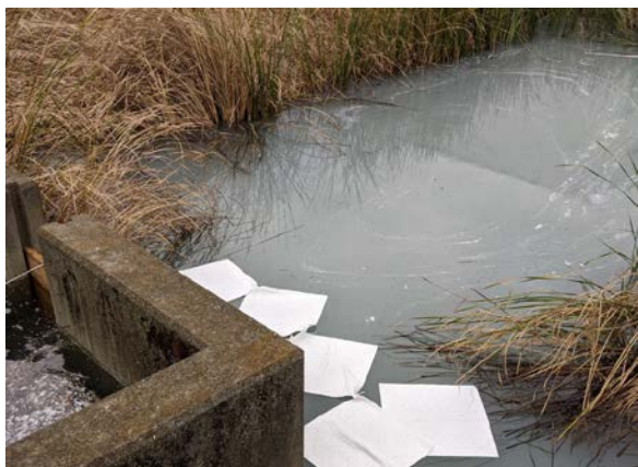
濁水を堰止めて水質検査
