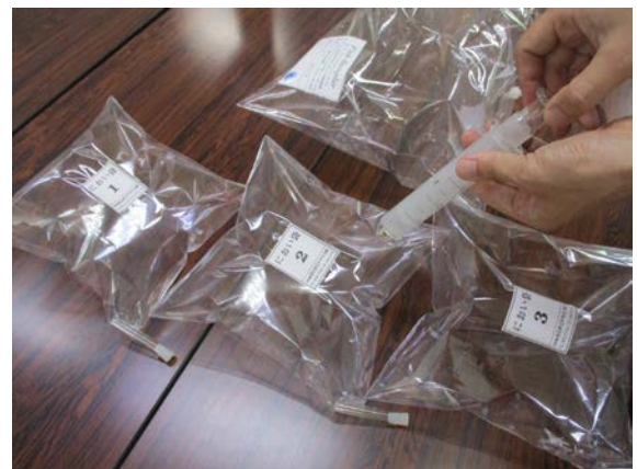
測定のため臭気を希釈する作業
