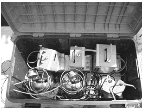
キャニスター及び吸引装置 ベンゼン、トリクロロエチレンなどの 揮発性有機化合物
