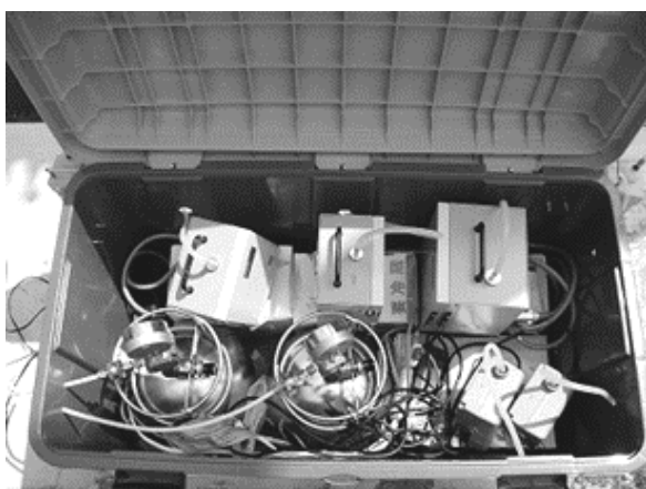
写真「キャニスター及び吸引装置」 ベンゼン、トリクロロエチレンなどの揮発性有機化合物を捕集
