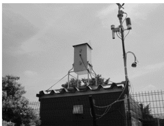
写真「ハイボリュームイエアサンプラー」 ニッケル化合物、マンガンなどの重金属類を捕集
