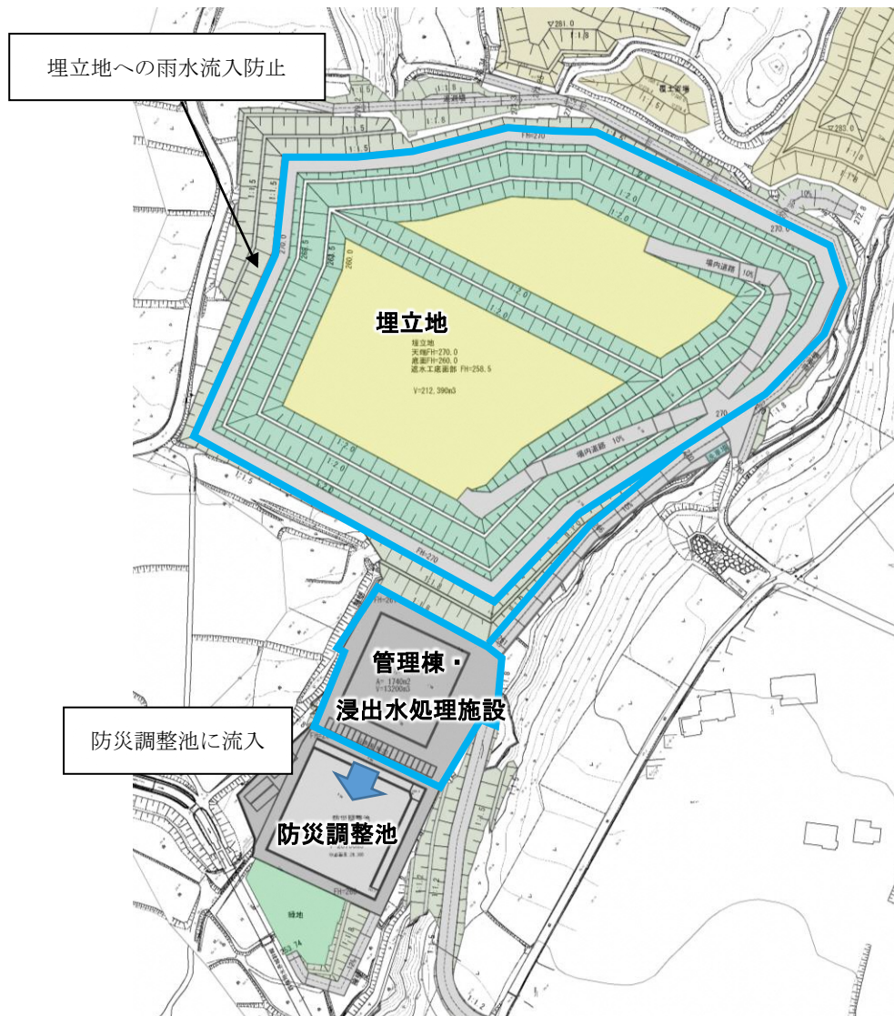
図 4-10 雨水集排水施設の基本的な配置
