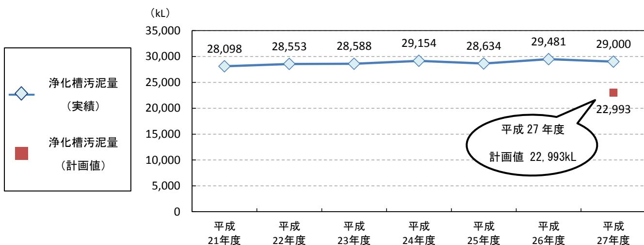
図 3-4 浄化槽汚泥量の推移と平成27年度の計画値
