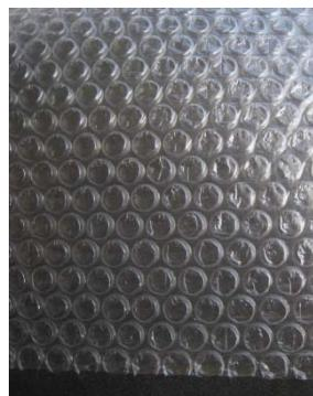
中空構造資材の構造（例）
