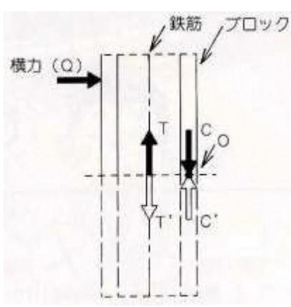
左の図は、ブロック塀の壁体部における鉄筋とブロックとの力の釣合モデルです。ブロック塀は、地震や風による横からの力  $(Q)$  を受けると、点Oを中心として回転しようします。
