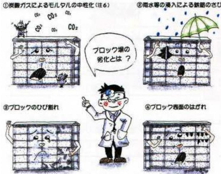
\* 注6 中性化とは、モルタルと炭酸ガスとの反応により、モルタル中のアルカリ性が低下し、鉄筋の保護機能が失われる現象をいう。
