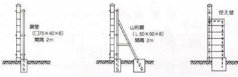
① 鋼柱(鋼管)式
