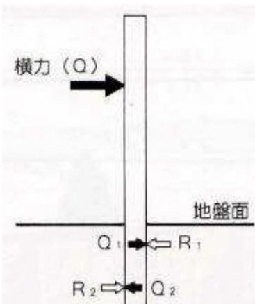
壁体の倒壊には、ブロックと鉄筋が抵抗します。
