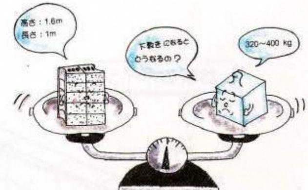
高さ1.6m、長さ1mのブロック塀の重さは、320~400kgです。例え、その破片であっても、私たちの力で支えられるものではありません。倒壊などにより、高いところから直撃を受けると、重大な事態が生じます。
