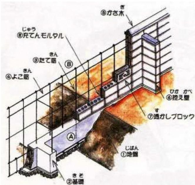
②基礎は鉄筋コンクリートで堅固に造り、塀本体と一緒に転倒しないように、40cm以上地中に根入れします。さらに、抵抗力の大きい形式の基礎として、L形、T形及び鋼管杭打ち基礎などがあります。また、高い擁壁や石積みの上に設けられている塀は、基礎に粘りがなく非常に危険です。
