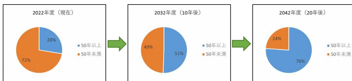
図 2-2 建設後50年以上経過する橋梁の推移
