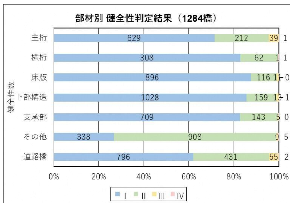
図 2-4 各部材の損傷状況
