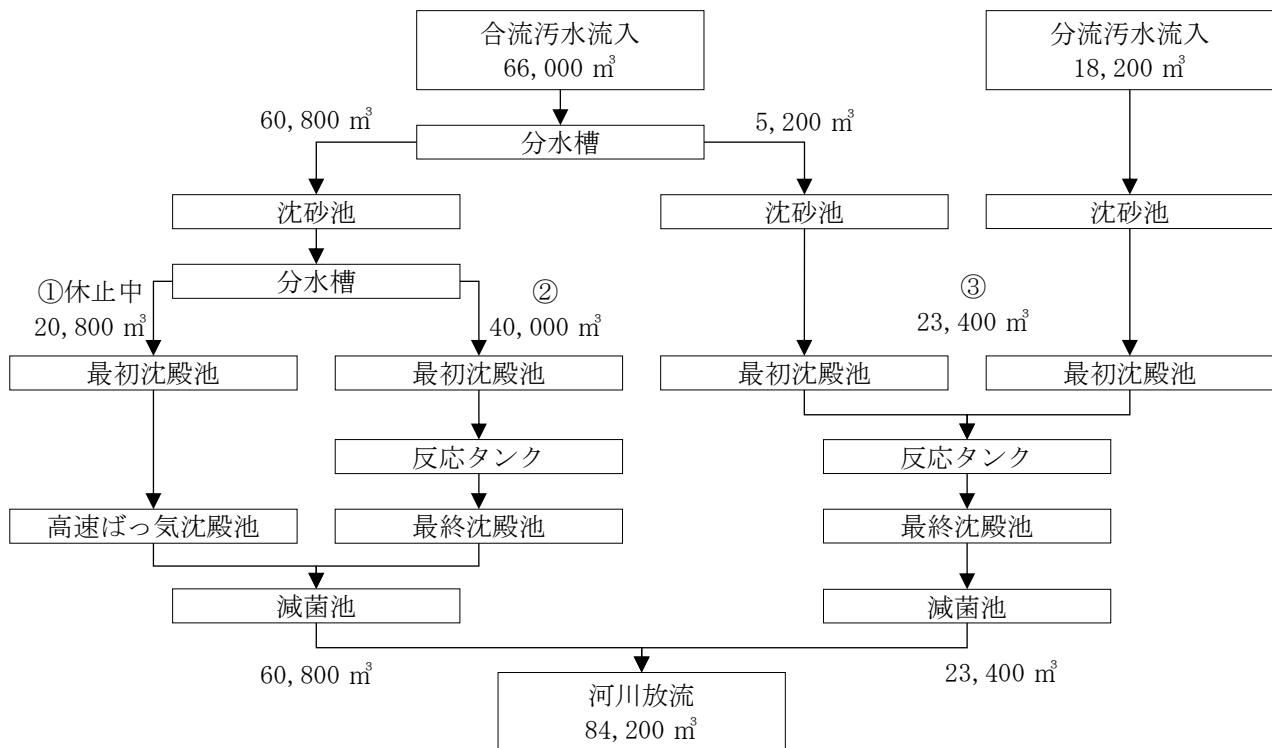
※最初沈殿池からの汚泥は、汚泥処理設備へポンプ搬送。
