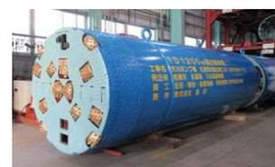
天川ポンプ場圧送管地震対策工事の第Ⅱ期工事で使用している推進機
