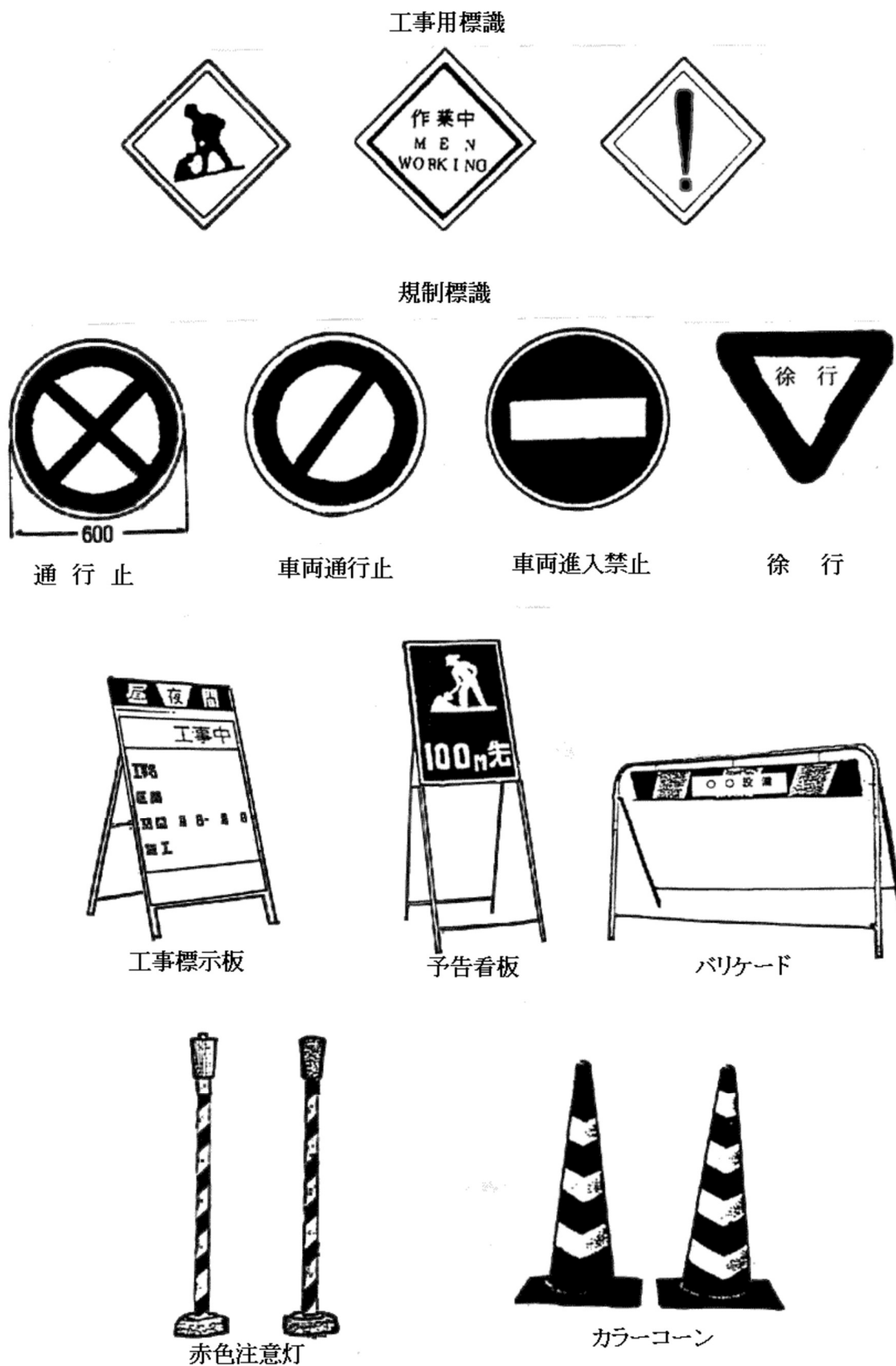
図 2 3 工事標示板等
