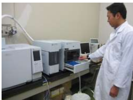
PT-GCMSによるVOCの検査
