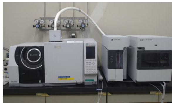
ガスクロマトグラフ質量分析計による揮発性有機化合物の検査
