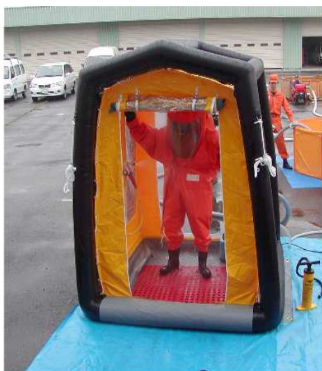
除染シャワーで化学防護服に付着した汚染物質を洗浄するもの。
