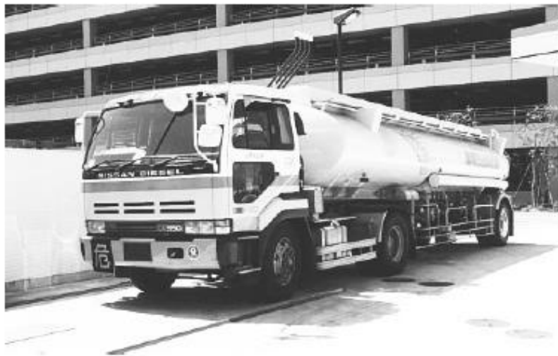
移動タンク貯蔵所
