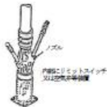
第 10-65 図 ノズル格納装置による方法の例
