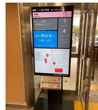
バスロケーションシステム
