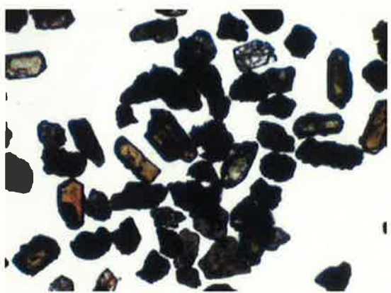
写真 6. No.4 地点・試料 8 の顕微鏡写真 (透過光) 中央左など (おもに褐色) : 斜方輝石。中央右下 (緑色) : 単斜輝石。 0.2mm
