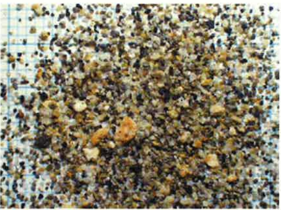
写真 3. No.4 地点・試料 1 の顕微鏡写真 (落射光) : 淡灰色、淡褐色、褐色の軽石型ガラスが多く含まれている。背後は 1 mm メッシュ。
