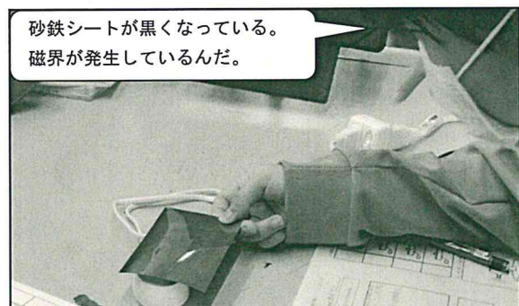
図6 「テーマ実験 ウ」 砂鉄シートで磁界の発生を調べている様子
